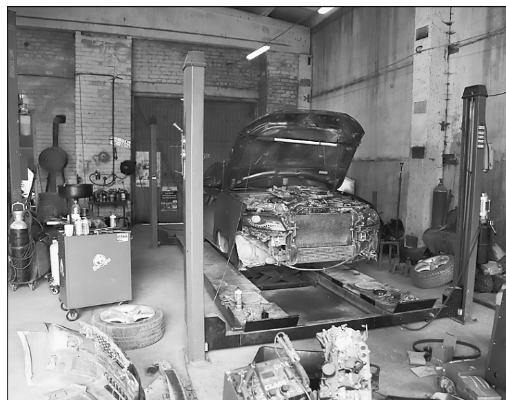
LEADER un LAD projekti sniedza iespēju iegādāties aprīkojumu, lai klientiem piedāvātu pilnu pakalpojumu klāstu, viena no šīm iekārtām — četrstatņu pacelājs.
