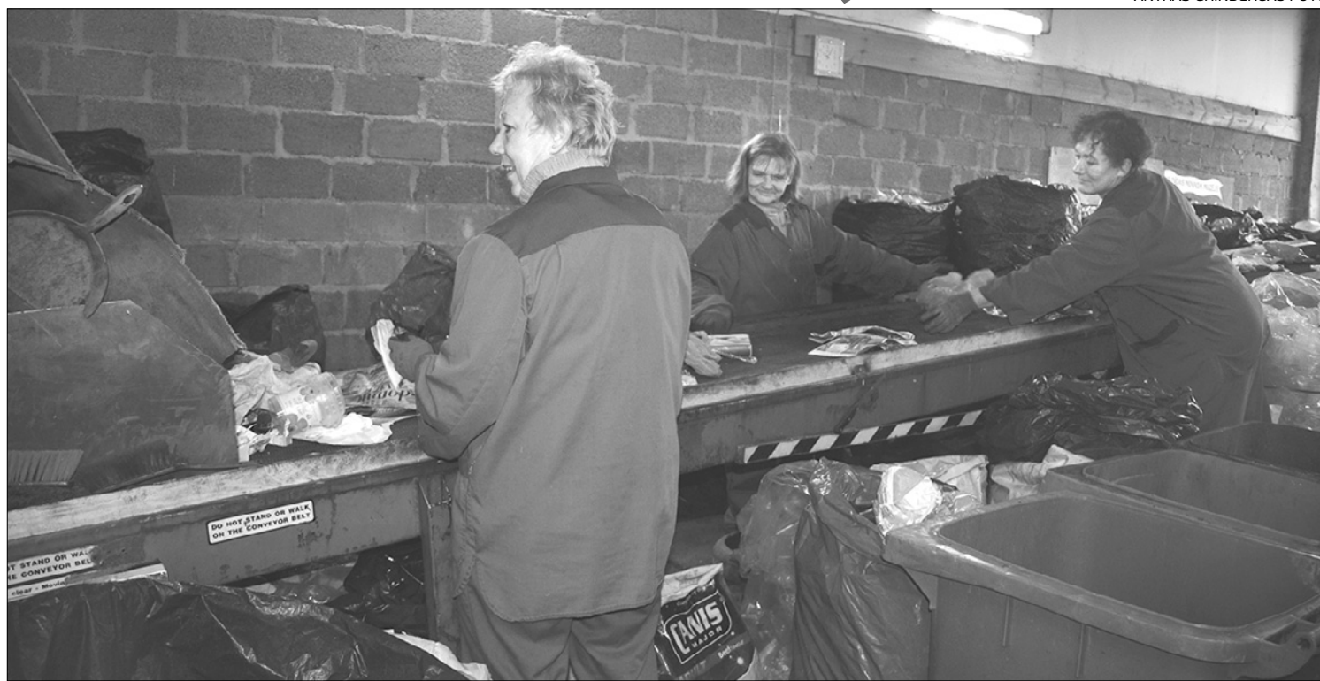
"Kuldīgas komunālo pakalpojumu" atkritumu šķirošanas laukumā uzbūvēta līnija, kas atvieglo strādnieku darbu un ļauj atkritumus ātrāk sadalīt pa frakcijām.
